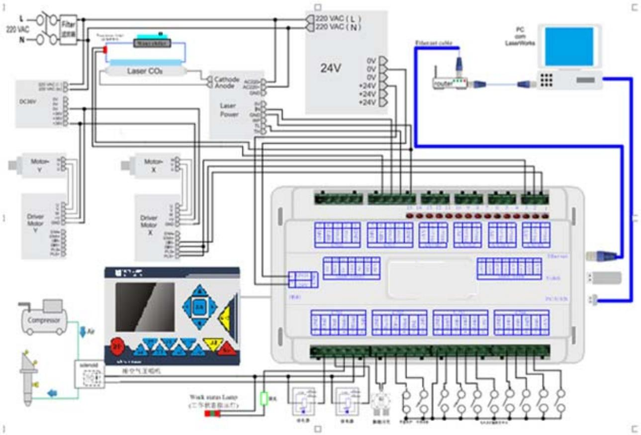
图 3.3-1 控制系统电气连接图
