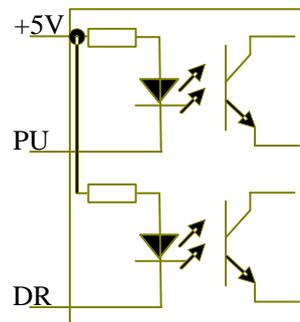
图 6.1-2 三输入，驱动器输入信号共阳
