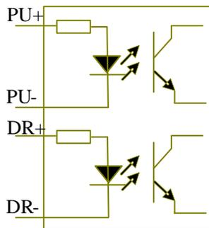
图 6.1-1 四输入，驱动器输入信号独立
