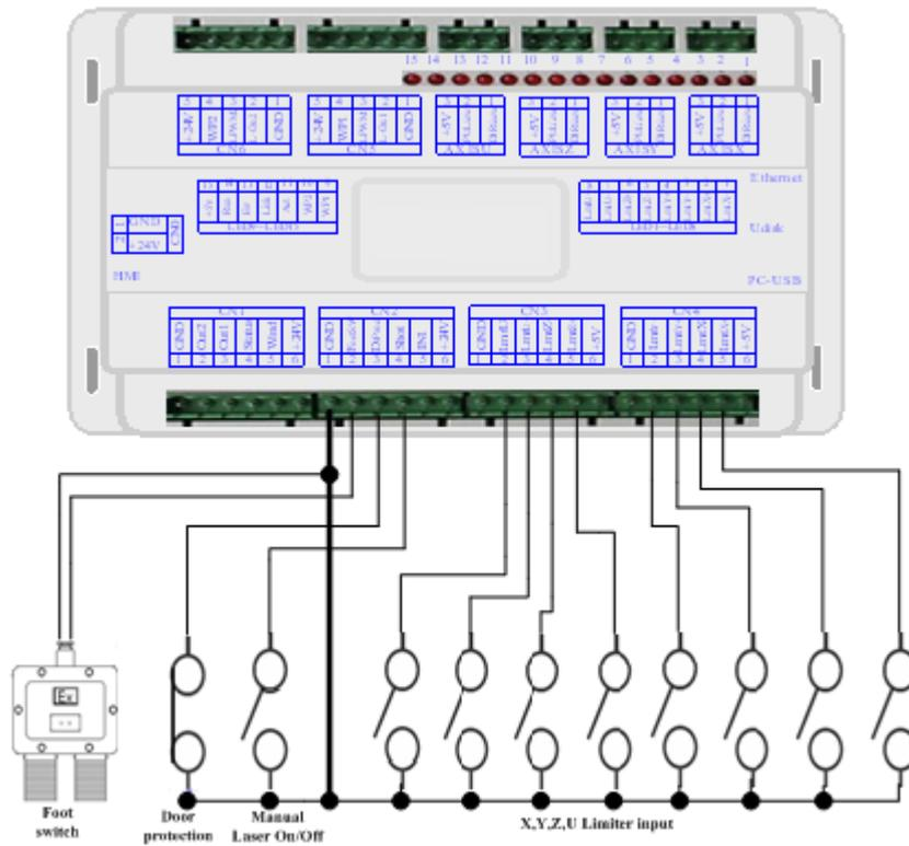
图 7.1-1 输入口接法示例
