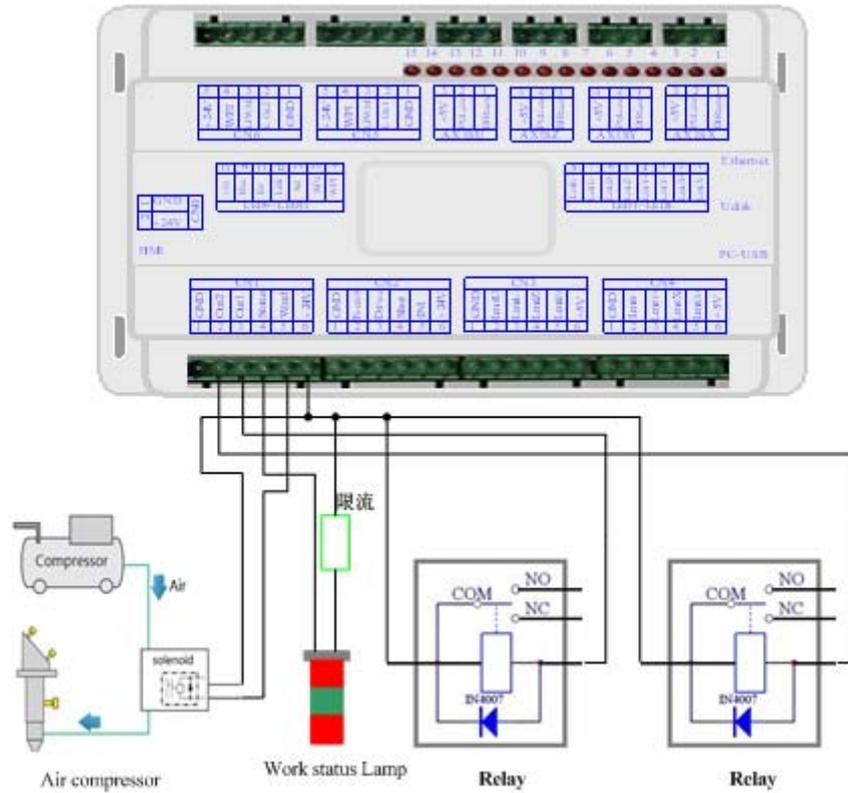
图 7.2-1 输出口接法示例
